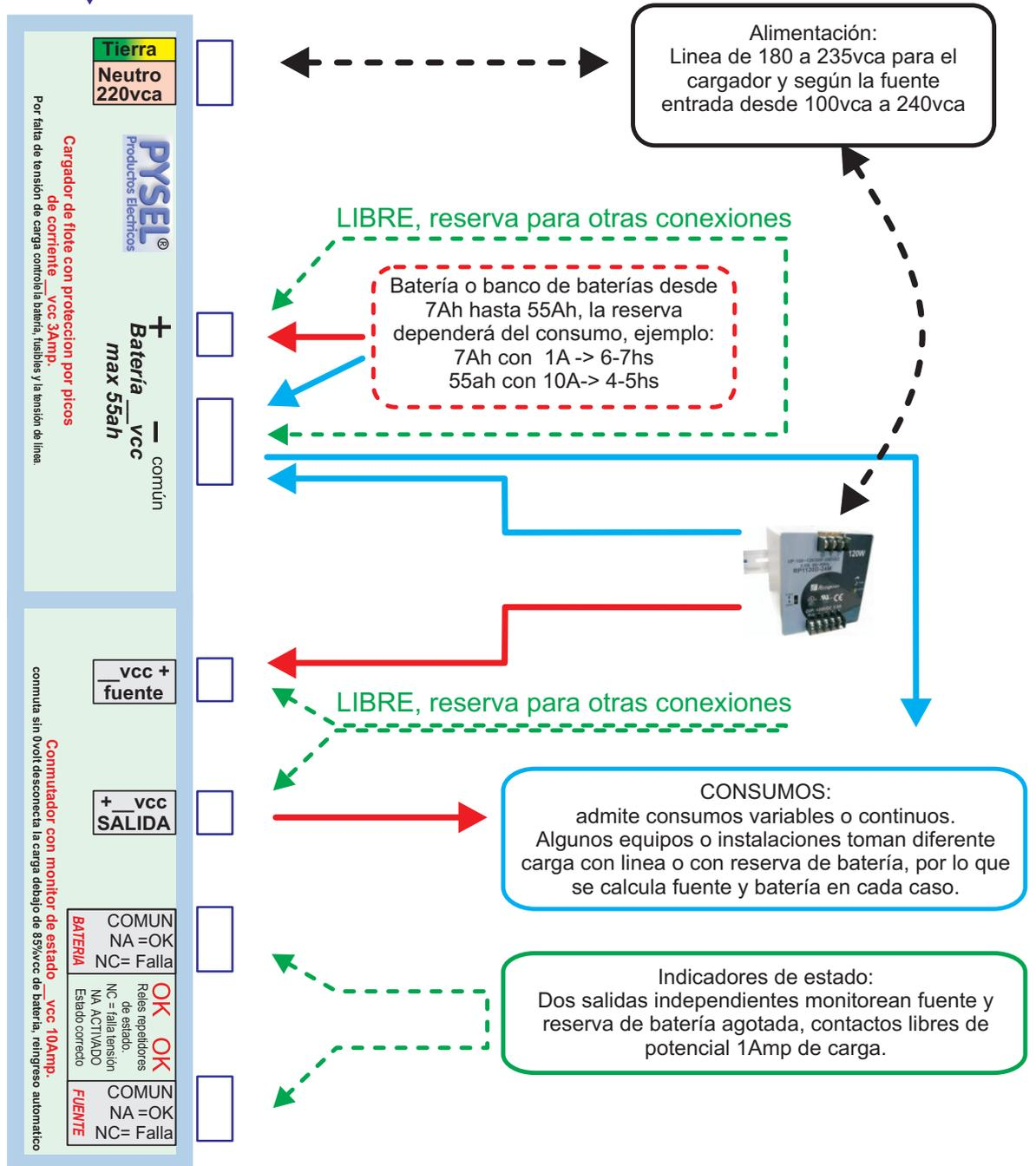
Detalle de conexión de sistema ininterrumpido componible rango 12v, 24v, 48v de 1Amp a 10Amp
