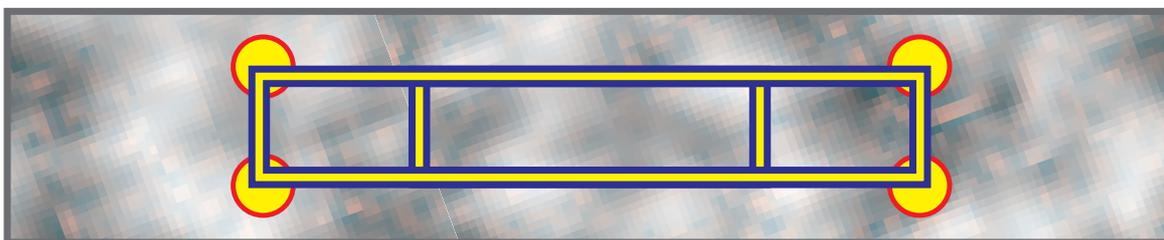
Ejemplo : Placa 400x2000 25mm,  $200\text{kg}/\text{m}^2 \Rightarrow 160\text{kg}$ , 4 Imanes de 100kg
